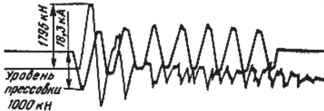
Рис. 7. Оциллограмма тока устройства РОСТ и осевой силы, действующей на модель обмотки при испытаниях
